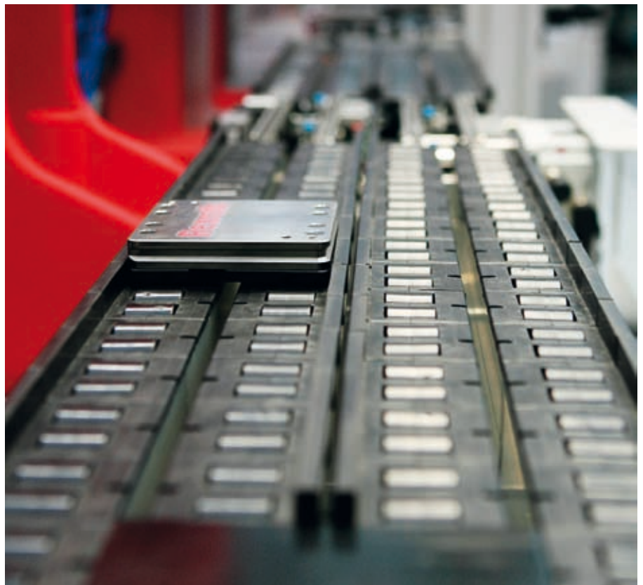
Bei der Inbetriebnahme hilft ein modulares Maschinenkonzept, da funktional autarke Module separat vorgetestet werden können. (Bilder: Reed Exhibitions Messe Salzburg)
